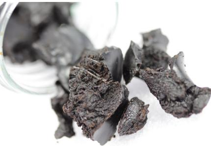
Forschungsverbund mit Beteiligung der Volkswagen AG entwickelt Schäume mit einem Ligninanteil von über 90 Prozent für Kernelemente von Pkw-Stoßfängern
