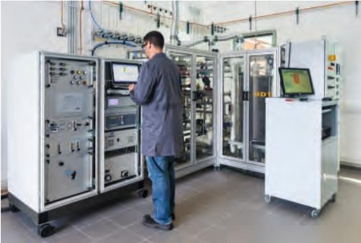
Abb. 54: Methanisierungsprüfstand am DBFZ
