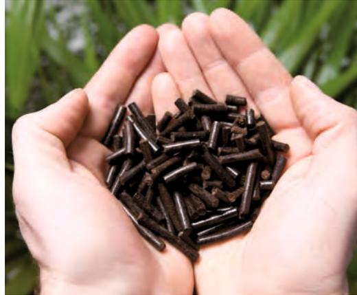
Abb. 40: Pellets aus torrefiziertem Material
