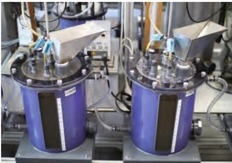
Abb. 47: Volldurchmischte Rührkesselreaktoren im Biogaslabor des DBFZ
