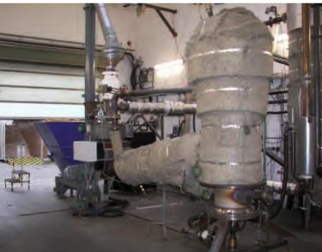
**Abb. 17: Zweistufiger Biomassevergaser (Pyrolyse-Gleichstrom-Wirbelschicht) – Eigenentwicklung der Stadtwerke Rosenheim**
