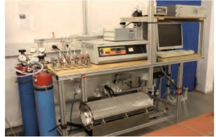
Abb. 25: Apparatur zur Testung und Charakterisierung von Katalysatoren am DBFZ
