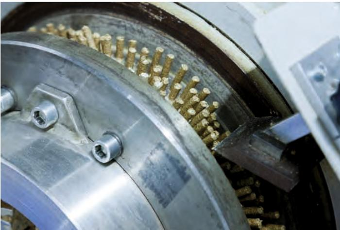
Abb. 52: Pelletherstellung im Kompaktierungstechnikum
