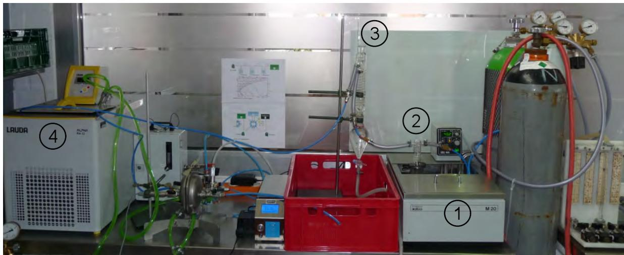
Abbildung 11: Gaspermeation – Messaufbau
