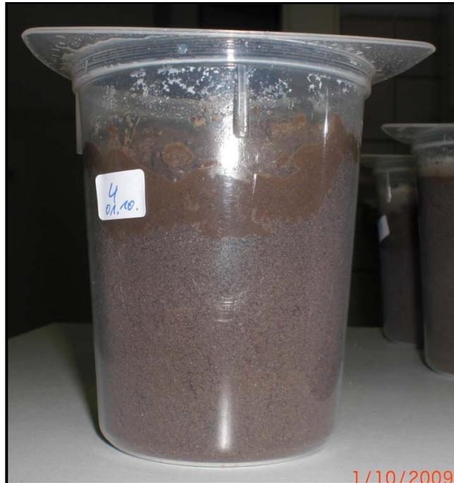
**Abbildung 1:** Gefäß gefüllt mit RefeSol und aufgetragener Folie
