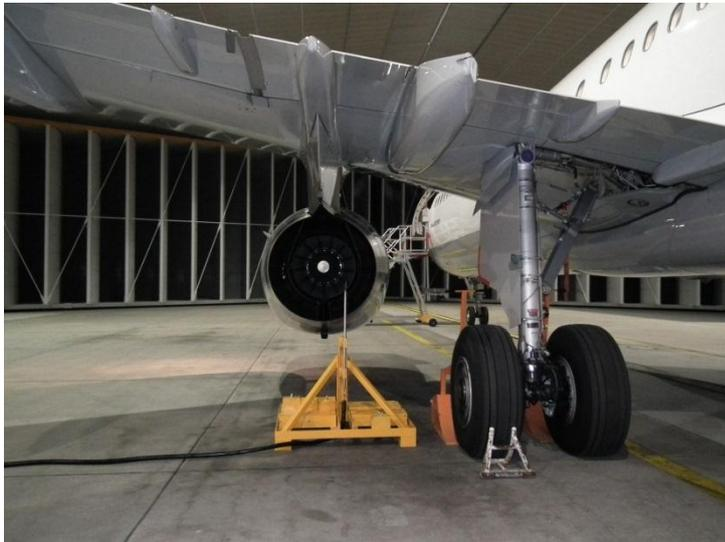
**Abbildung 3.1:** Sonde mit Sondenhalterung hinter dem Triebwerk
