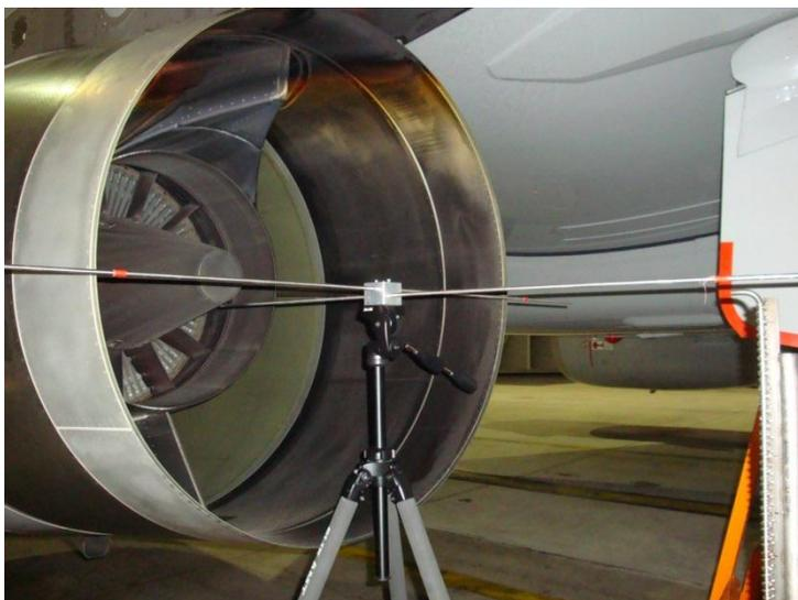
**Abbildung 3.3:** Positionierlehre zur Festlegung der Sondenposition
