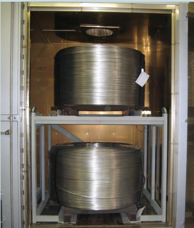
Thermokammer der Abkühl-/Aufwärmstation mit abgekühlten und erwärmten Coil
