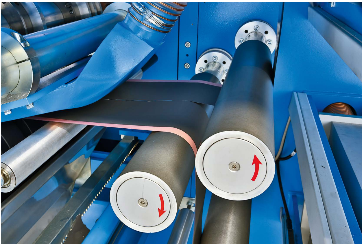
Batteriefertigung: Längsteilung von Elektrodenbändern zur effizienten Materialnutzung
