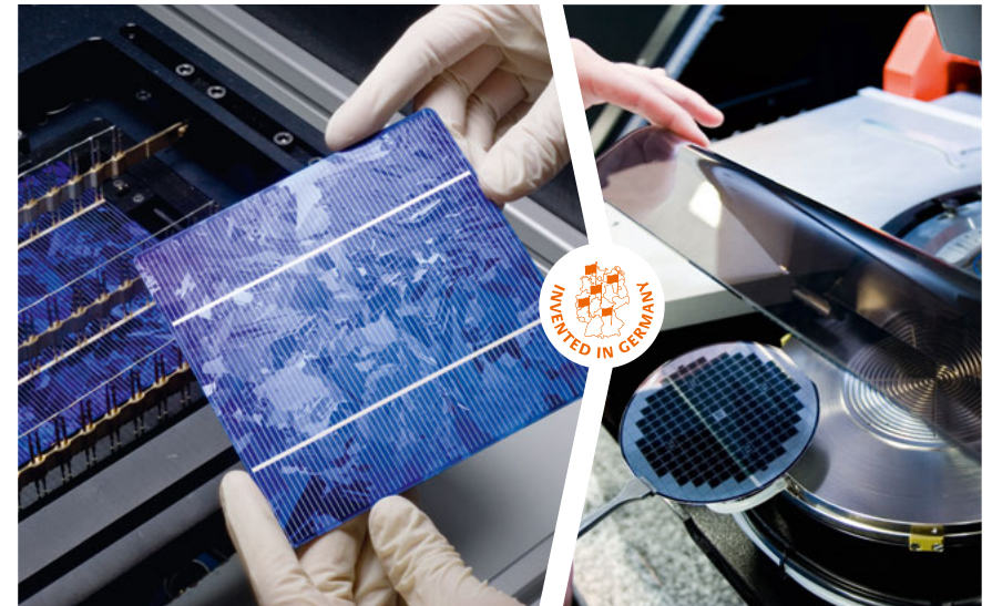
Standard-Silizium-Solarzelle, Entwicklungsplattform für Hocheffizienz-Solarzellen/ Standard silicon solar cell, Development platform for high-efficiency solar cells
