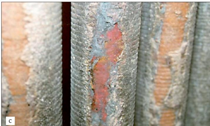
c) Überhitzerschott auftragsgeschweißt, Dampftemperatur 410°C, Abzehrung bis zum Grundmaterial nach 8.700 h
