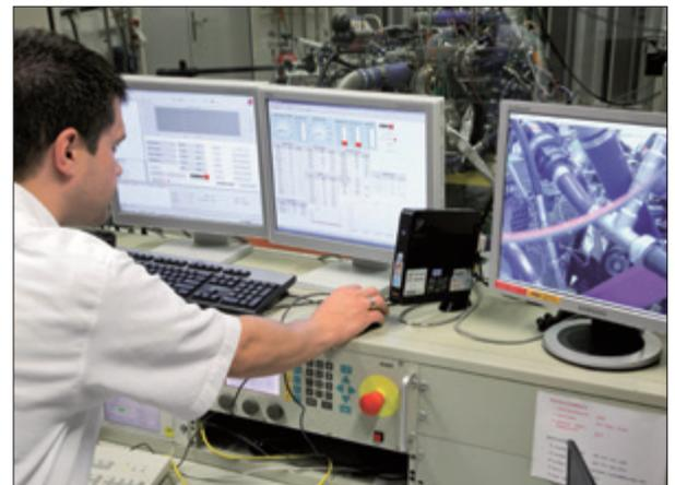
Dynamischer Motorprüfstand zur Untersuchung von Autoabgaskatalysatoren.
