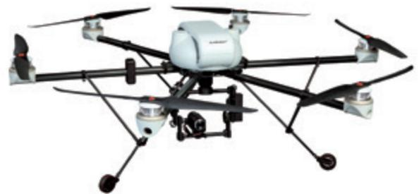
Mobile Unmanned Aerial Vehicle (MUAV) für Inspektionen an Offshore-Windenergie-Anlagen, Maße im Flugbetrieb: Breite = Länge = 2,20 m; Abfluggewicht: ca. 10 kg
