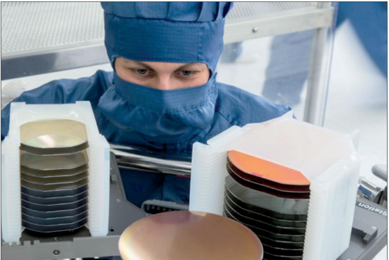
Blick in den Reinraum: Die Bestückungsanlage transportiert einen 6-Zoll-Wafer, links sind 4-Zoll-Wafer zu sehen
