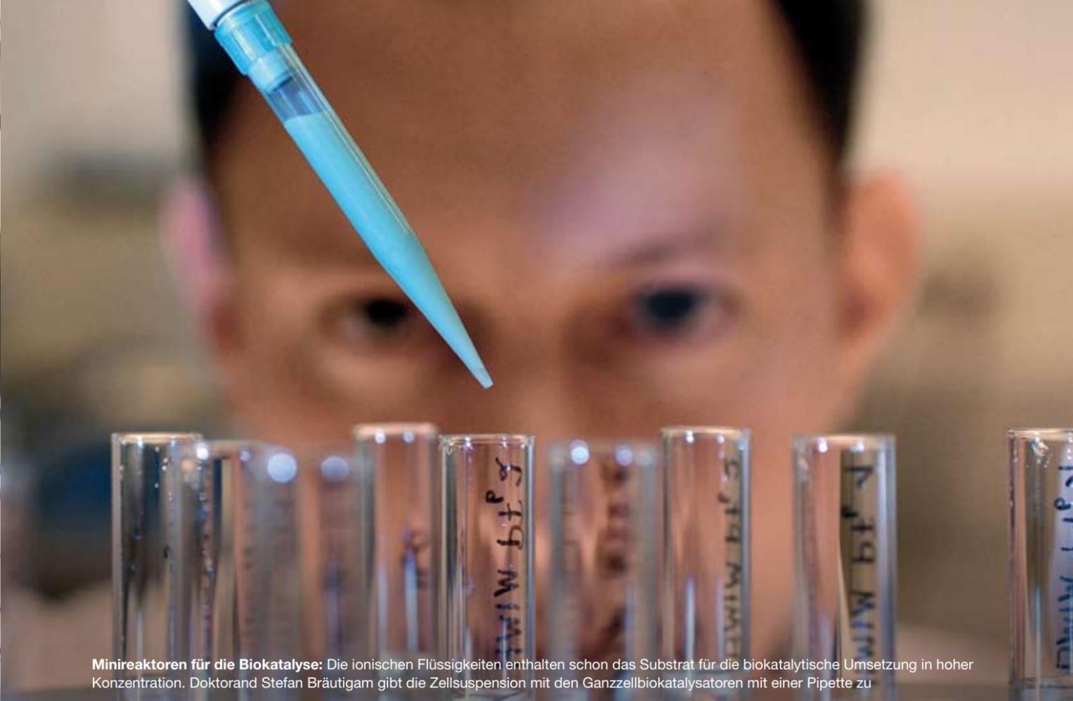
**Minireaktoren für die Biokatalyse:** Die ionischen Flüssigkeiten enthalten schon das Substrat für die biokatalytische Umsetzung in hoher Konzentration. Doktorand Stefan Bräutigam gibt die Zellsuspension mit den Ganzzellbiokatalysatoren mit einer Pipette zu
