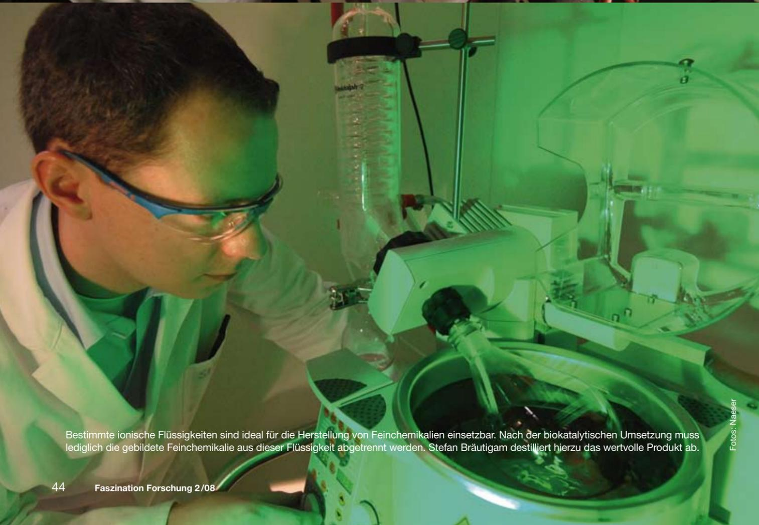
Bestimmte ionische Flüssigkeiten sind ideal für die Herstellung von Feinchemikalien einsetzbar. Nach der biokatalytischen Umsetzung muss lediglich die gebildete Feinchemikalie aus dieser Flüssigkeit abgetrennt werden. Stefan Bräutigam destilliert hierzu das wertvolle Produkt ab.
